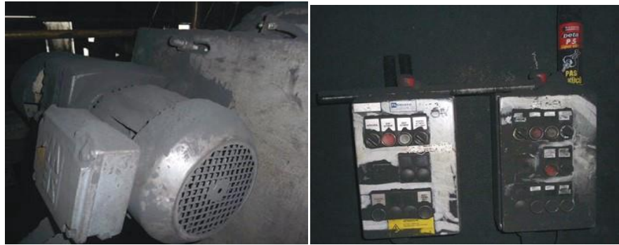
Fotoęraf 7 – Elektrikli Ekipmanlar Üzeri Aşırı Kömür Tozu Birikimi Örnekleri (İkincil Patlama Risklerini Tetikleyecek Durumlar)
