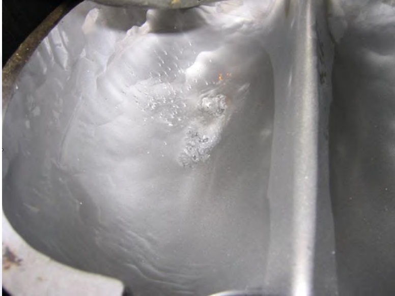
Őekil 24 - Trbin Kanatlarına Rsbat GiriŐine Bađl Hasar
