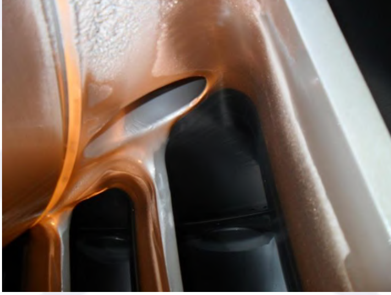
Őekil 23 - Trbin Kanatlarında Kavitasyon Hasarı
